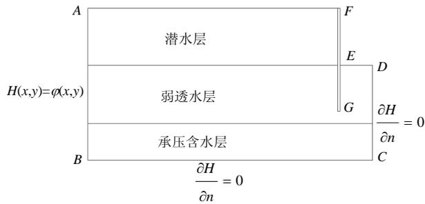
图 2 弱透水层承压水基坑二维渗流计算模型
