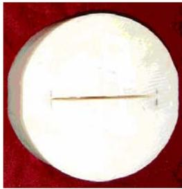
图 2 中心直裂纹平台巴西圆盘实物图
