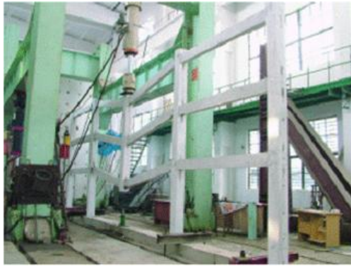
图1 湖南大学平面框架倒塌试验
